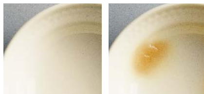
レンジアップメラミン 異常は発生せず
